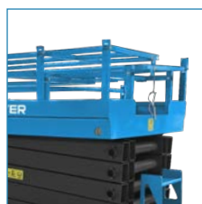
Складывающиеся поручни для удобства эксплуатации
