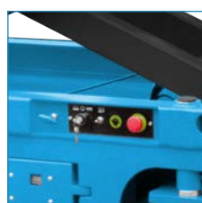
Кнопка аварийного выключения и система бортовой самодиагностики
